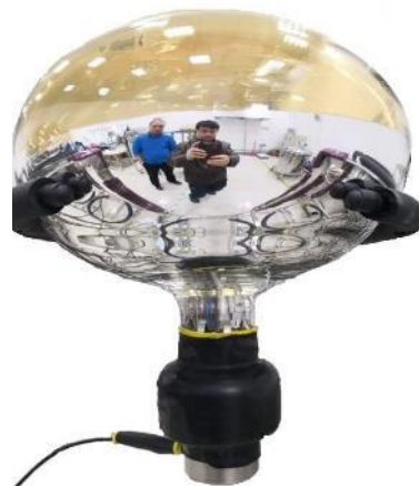
20英寸超大尺寸的光敏探头
